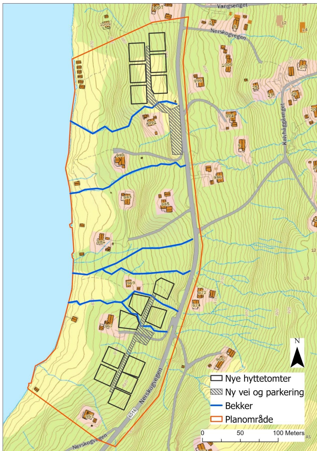
Figur 4: Planområdet (rødt omriss), med de 15 nye hyttetomtene (svart omriss) og ny vei og parkering (grå skravur). Bekker med vesentlig vannføring er markert med mørkeblått, men også mindre bekker, særlig sør i planområdet bør hensyntas.
