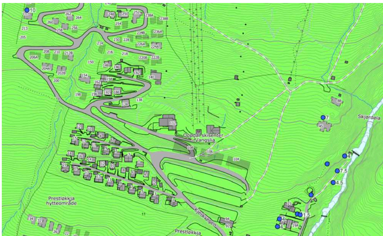
Figur 8. Lokasjon av borer benyttet i dette arbeidet vist i blått, tallene viser antatt dyp til fjell, se teksten for beskrivelse
