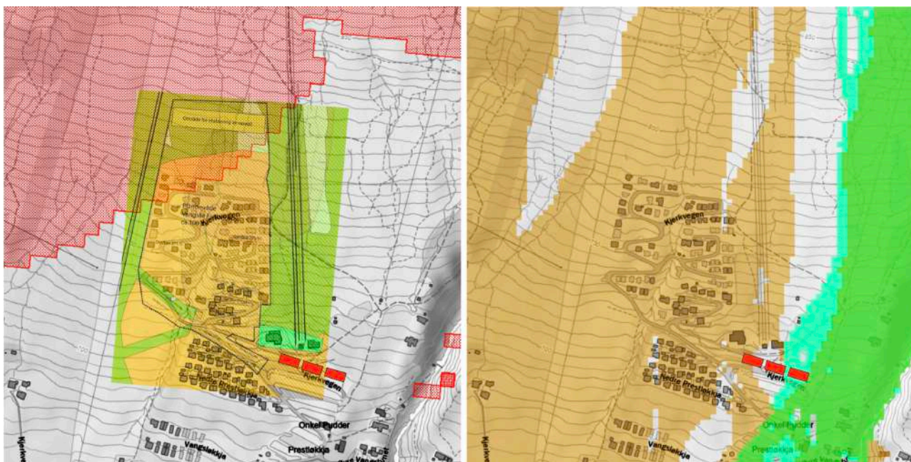
Figur 5. Til venstre utløpsområder for snøskred fra NVE, som viser at tomtene ligger i trygg avstand, overlatt området vurdert for skredvoll. Til høyre jord- og flom skred-kart fra NVE (lyse brun og grønn farge respektivt). Flom kartet er generert ved at vann vill renne i ski bakken heller enn ned i juvet der Skjørdøla går, mens tomtene ligger sør av hvor jordskred er beregnet å vill stoppe, se teksten for diskusjon
