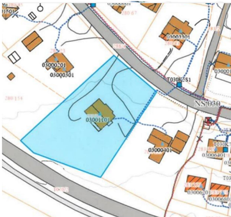
Fig. 6.6.1b Oversikt over kabelføringer og trafo
