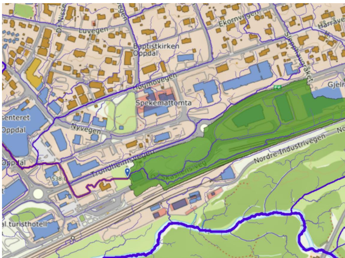
Figur 3: Scalgo-utklipp som indikerer flomvei via O. Skasliens veg og gjennom planområdet ved ekstremnedbør
