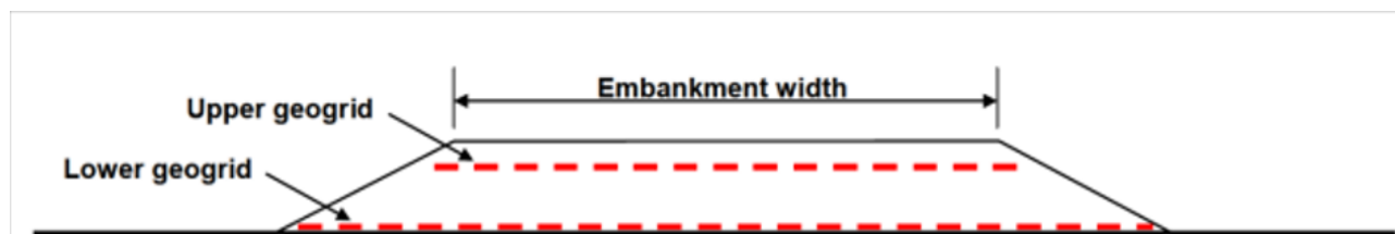
Figur 6: Prinsskisse av flytende veg med to geonett. "Geogrid" er geonett. Kilde: Rambøll.
