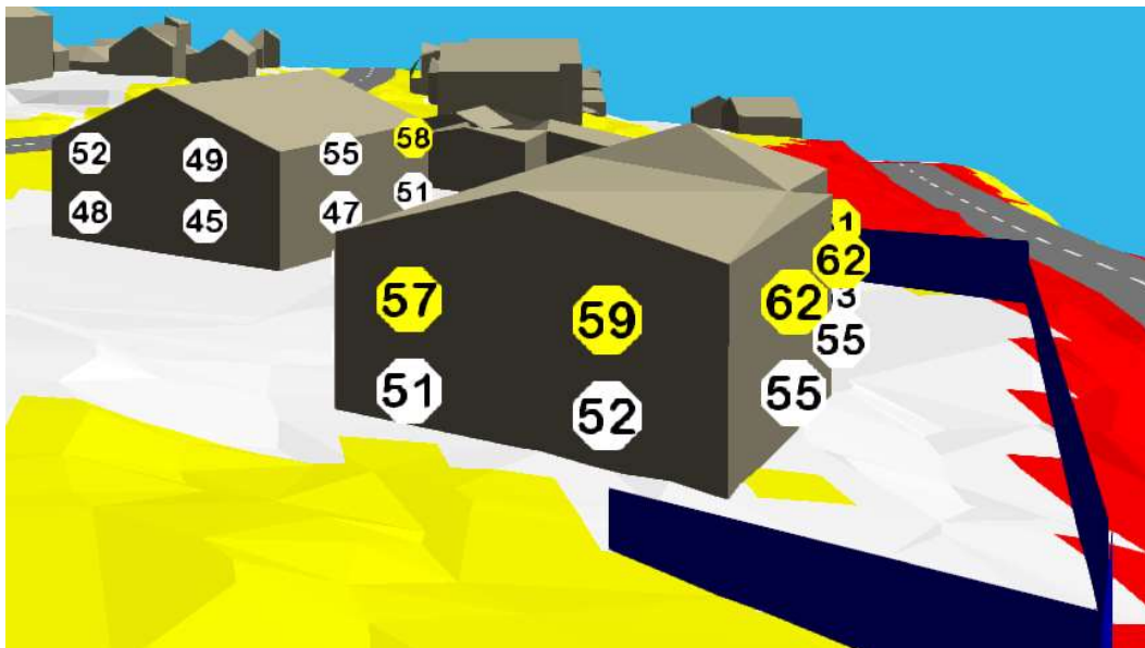
Figur 4: Beregnet ekvivalent støynivå L_{den} på fasader mot sør og vest for situasjon med støyskjerm.
